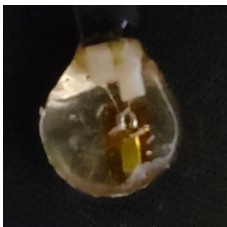
Рисунок 2 – Смещение тензорезистора в корпусе
