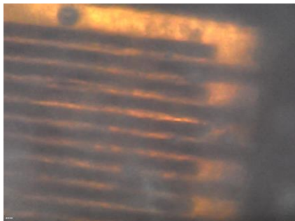
Рисунок 6 – Пузырьки воздуха на фоне решетки тензорезистора
