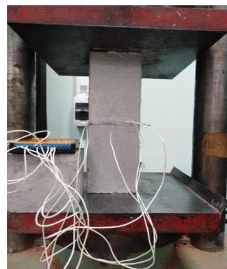
Рисунок 15 – Призма, подготовленная к испытаниям
