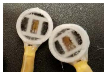
Рисунок 11 – Готовые датчики с кондуктором
