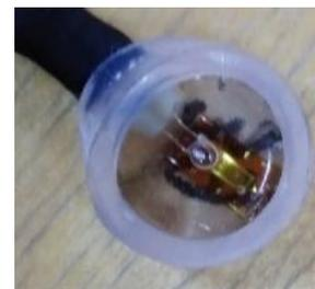
Рисунок 13 – Датчик с демпфером
