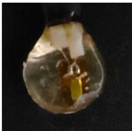
Рисунок 2 – Смещение тензорезистора в корпусе
