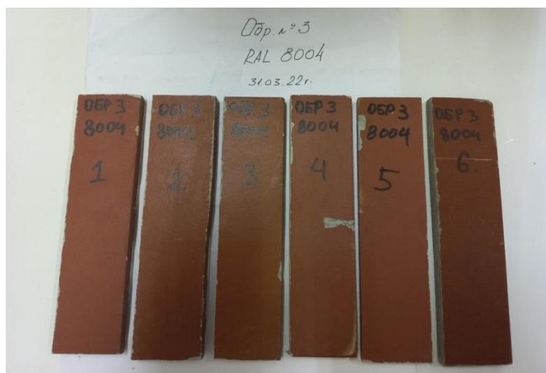
Рисунок 3 – Общий вид образцов фиброцементных плит красного цвета до испытаний с лицевой поверхности
