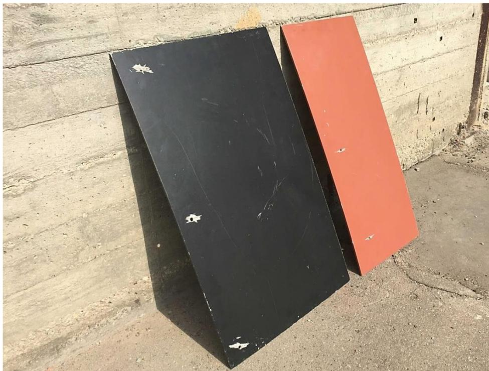
Рисунок 5 – Общий вид образцов во время определения температуры нагрева поверхности плит
