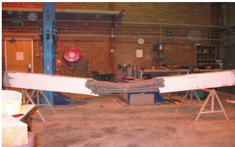
Рисунок 2 – Общий вид образца со спиральным армированием после нагрузки
