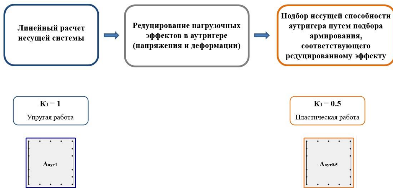
Рисунок 5 – Блок-схема методики использования коэффициента редукиции для обеспечения устойчивости монолитных железобетонных несущих конструкций к прогрессирующему обрушению
