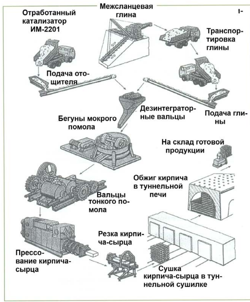
Рисунок – Технологическая схема производства керамического кирпича Figure -Technological scheme of production of ceramic bricks
